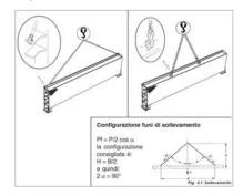
Nel caso di movimentazione dei carichi con l'ausilio di gru, paranchi e carroponte, l'operatore terra conto:
