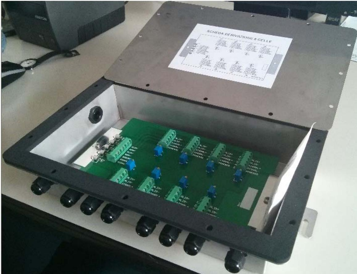
Scatola di giunzione in acciaio inox AISI 304 con grado di protezione IP 66 da acqua e polveri, dotata di scheda elettronica di derivazione per unione e equalizzazione di 4/6/8 celle di carico. Morsettiere a vite per agevolare il collegamento delle celle di carico e dotata di trimmer di regolazione del segnale, per una equalizzazione precisa ed affidabile.
