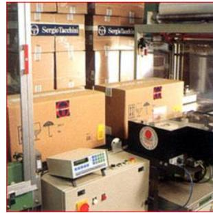
Controllo della produzione tramite il peso
