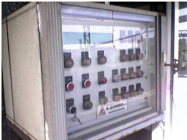
**UN QUADRO DI CONTROLLO ESTERNO AL BOX DI PESATURA ED UNA TASTIERA INDUSTRIALE, PERMETTE DIRETTAMENTE ALL'OPERATORE ADDETTO AI VAGONI FERROVIARI DI IMPOSTARE LA TIPOLOGIA DEL CARRO E LA QUALITA' DEL PRODOTTO DA PESARE .**
