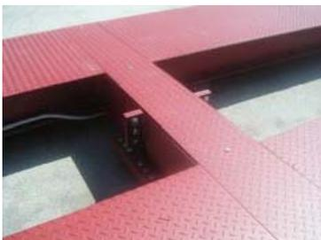
Grazie alla presenza di botole di ispezione trasversali, è possibile eseguire facilmente l'accesso alle celle di carico.
