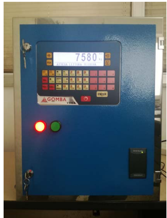
VEGA AN SELF predisposto con dispositivo a radiofrequenza
