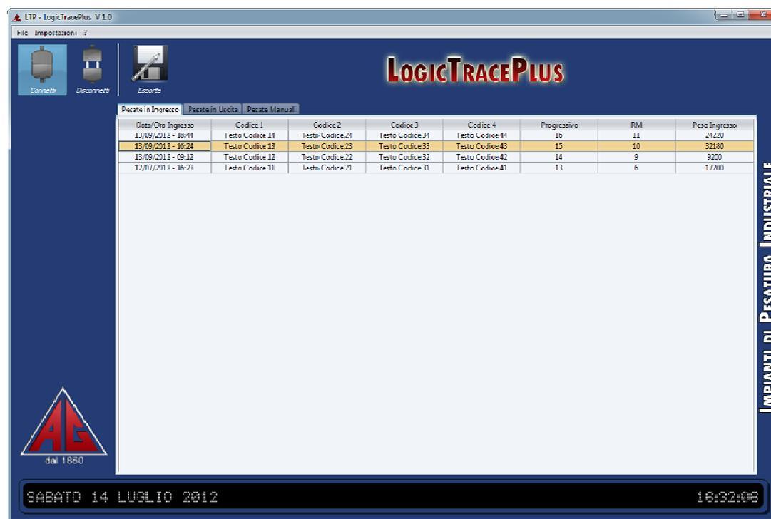
L'applicativo è un programma che permette all'utenza la visione in tempo reale e l'archiviazione delle operazioni di pesatura provenienti dal terminale collegato al computer.
