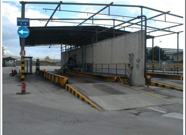
Vista delle bilance poste sopra pavimento e realizzate per ambienti esplosivi
